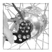
Der Schaltseilwechsel erfolgt grundsätzlich im 14. Gang. Sollte dies aufgrund eines Defektes nicht möglich sein, erfolgt das Schalten in Gang 14 zu einem späteren Zeitpunkt (siehe Punkt 6/7). Die 4 Kabelbinder an den Enden der Faltenbälge mit einem Seitenschneider durchtrennen.
