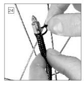
Obere Enden der Faltenbälge auf die Bajonettspitzen stecken, Kabelbinder auf die Nut der Bajonettspitzen ansetzen und Faltenbälge fixieren.
