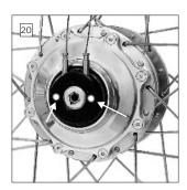
Achsring mit Seilrolle in dieser Position halten und mit den Paßstiften in Achsbohrungen setzen. Darauf achten, daß der Innensechskant der Seilrolle mit dem Außensechskant der Schaltwelle fluchtet, und ganz auf die Schaltwelle schieben. Eventuell die Stellung der Seilrolle etwas nach links oder rechts korrigieren. Achsplatte montieren (Achtung: Stellung der Achsplatte zur Zugführung beachten!) und die 6 Senkkopfschrauben über Kreuz anziehen (Torx 20-Anzugsmoment: 3 Nm / 25 in.lbs.)
