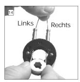
Das vordere Schaltseilende ca. 2 ½ mal auf die Seilrolle aufwickeln, das rückseitige Schaltseil nicht aufwickeln. Dann das rückseitige, nicht aufgewickelte Schaltseil (längeres Schaltseilende) durch die rechte Zugführung führen. Das vordere, aufgewickelte Schaltseilende (kurzes Schaltseilende) durch die linke Zugführung. Diese Arbeit wird wesentlich vereinfacht, wenn der Achsring durch eine zweite Person gehalten wird!
