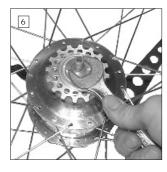
Wie bei erwähnt, darf die Montage nur im 14. Gang erfolgen. Damit sich beim Schalten die Achse nicht mitdreht, muß die Alu-Verschraubung (auf der Ritzelseite) mit einem Gabelschlüssel SW 17 festgehalten werden!
