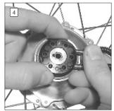
Laufrad mit Achsring nach oben auf die Arbeitsfläche legen, dabei Zugführung nach rechts ausrichten. Zugführung mit der rechten Hand zwischen Zeigefinger und Daumen festhalten. Achsring durch Aufund Abkippeln, mit der rechten Hand lösen und dabei gleichzeitig mit der linken Hand Achsring nach oben abziehen. Darauf achten, daß die beiden Freilauffedern nicht aus den Paßstiftbohrungen der Achse herausgezogen werden. Falls doch, unbedingt wieder einsetzen.
