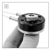
Seilrolle von der Rückseite (Stahlring) des Achsrings herausdrücken. Dabei evtl. am Schaltseil ziehen. Das alte Schaltseil aus der Seilrolle entfernen.
